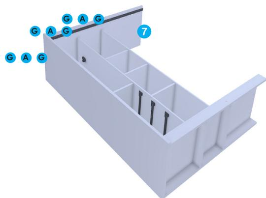
Coloca la tapa superior 7 mediante 2 tarugos y 1 tornillo en cada panel 3, 13,9,4
