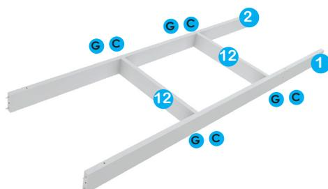
Montar la base encastrando mediante los tarugos de madera las piezas 12,2,1 Las piezas centrales (12) se refuerzan con tornillos
