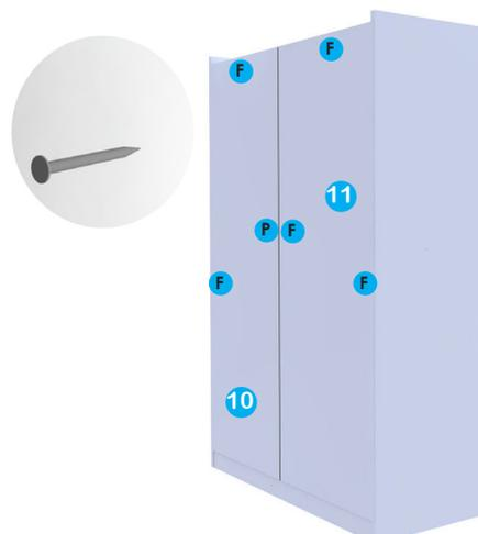
Clavar los fondos 10 y 11 a los paneles laterales y al panel superior. En el centro entre fondos unir ambos utilizando las piezas union (34) de fondo las cuales deben clavarse en los paneles internos.
