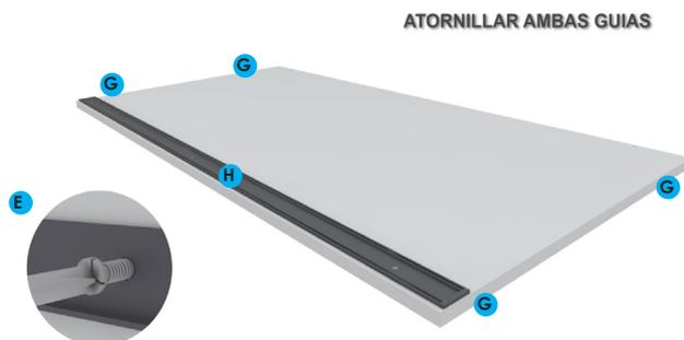
Montar las guías de puerta se colocan atornilladas en el panel inferior (8) y en el panel superior (7). Dejando 1,5 cm del canto.
