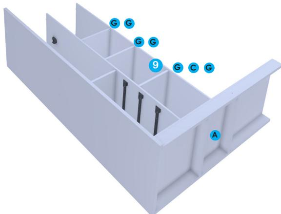
Montar el panel 9 encastrando los tarugos de los estantes 25,22 y 23 a su vez unir a la base 8 mediante 2 tarugos y reforzar con un tornillo por debajo.
