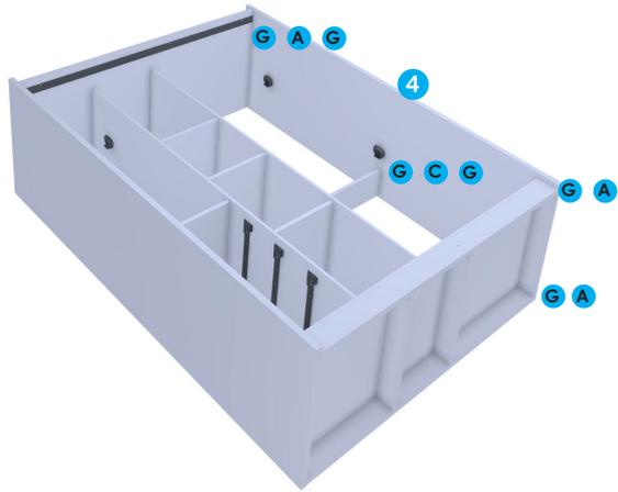
Montar el panel 4 mediante 2 tarugos y 1 tornillo a los zocalos de la base 1 y 2, al estante 6 y a la tapa superior 7
