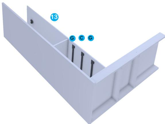
Montar el panel 13 mediante 2 tarugos a la base 8 y reforzar con un tornillo por debajo y encastrar al estante 5 con 2 tarugos y un tornillo
