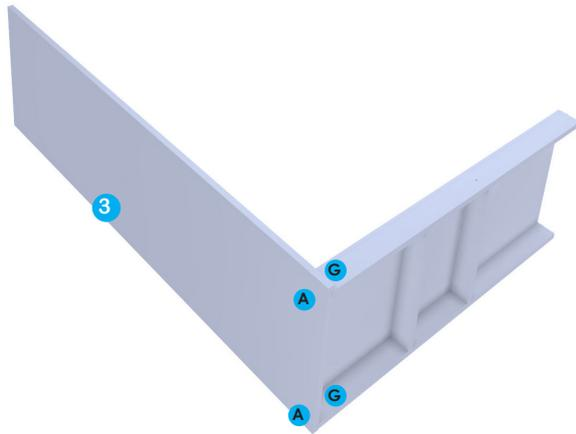
Colocar la base en la posición indicada para facilitar el armado y montar el panel lateral 3 mediante los tarugos de la base y 2 tornillos
