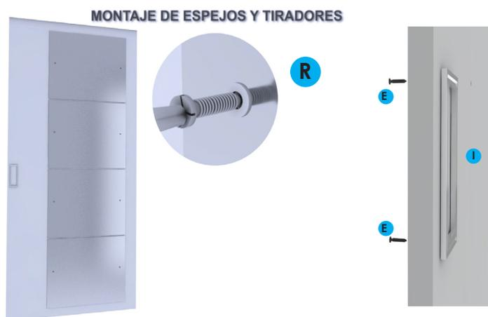
Colocar los espejos en la puerta atornillados protegiendolos con arandelas de goma
