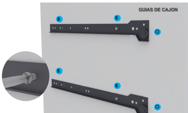
Colocar las guías de cajon en los paneles 3 y 13. Cuidar que la ruedas queden al frente.
