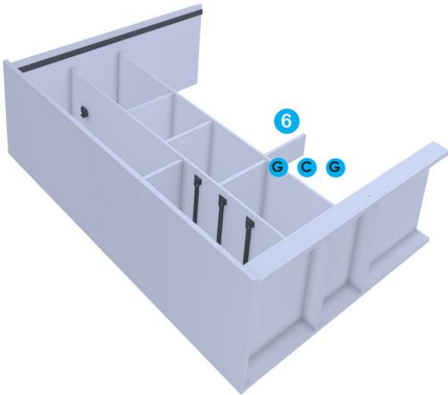
Montar el estante 6 mediante 2 tarugos y 1 tornillo a cada lado con los paneles 9 y 4
